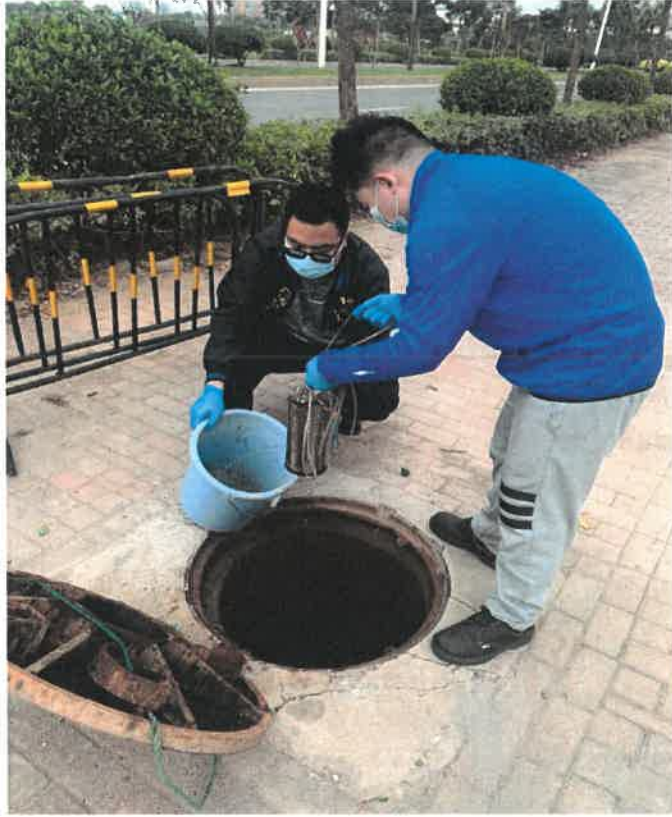
图 2：外部管网排查取样
